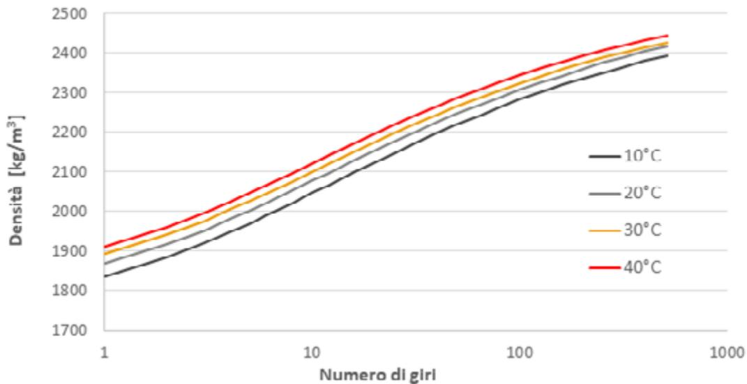
Fig. 1 Andamento della densità [kg/m<sup>3</sup>] al variare nel numero di giri a diverse temperature [°C] (piano semi-logaritmico)
