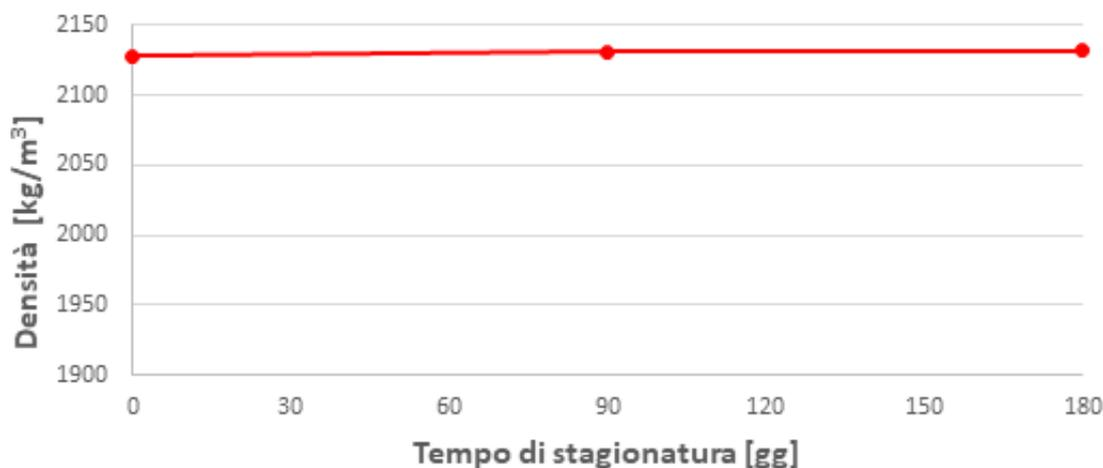
Fig. 2 Andamento della densità [kg/m<sup>3</sup>] al variare del tempo di stagionatura [gg]
